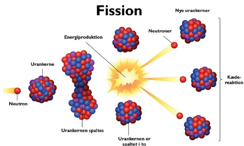
Billede på fissionsprocessen. Der skabes varme, som kan omdannes til strøm i fissionen.
